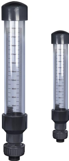
Truflo Calpro Series Calibration Columns ont été conçus pour mesurer les débits des pompes de dosage des produits chimique. The Calpro Series units fournissent une méthode économique pour déterminer le débit de la pompe en utilisant des graduations standard de millilitres/minute (ml/min. Ils offrent les tests précis du débit de la pompe de dosage en mesurant le débit d'aspiration, tout en laissant la décharge intacte dans son état normal de fonctionnement stable.
