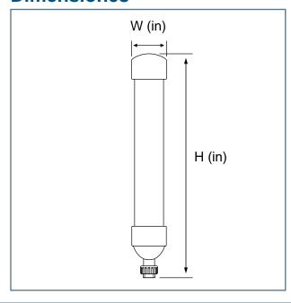
Las columnas de calibración Truflo Serie Calpro están diseñadas para medir tasas de flujo de bombas de medición para químicos. La Serie Calpro provee un método económico de determinar tasa de flujo de bombeo utilizando divisiones estándar de mililitros | minuto (ml/min). La medición se realiza en el lado de succión, dejando la descarga en la condición de operación normal.
