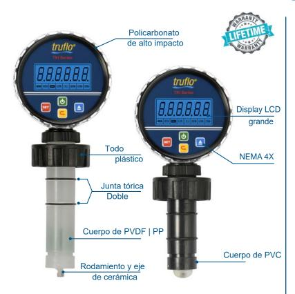
Simple de instalar y de rendimiento confiable, los sensores de flujo de rueda de paletas Serie TIB presentan una gran repetibilidad y ofrecen gran valor con poco o ningún mantenimiento. La Serie TIB tiene un rango de flujo dinámico de 0.1 a 0.6 m/s (o.3 a 20 ft/s). El sensor mide rangos de flujo en tuberia completa y puede ser utilizado en sistemas de baja presión.
